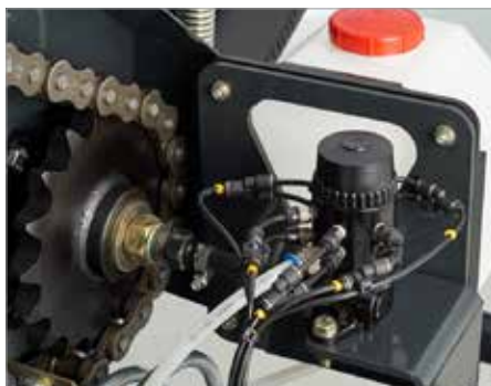
6. Система непрерывной смазки цепей ВЕКА-MAX
