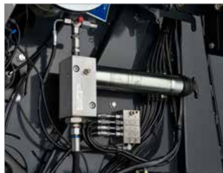
5. Стандартная система автоматической смазки роликовых подшипников
