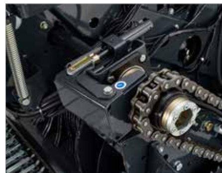
4. Стандартное гидравлическое отключение ротора
