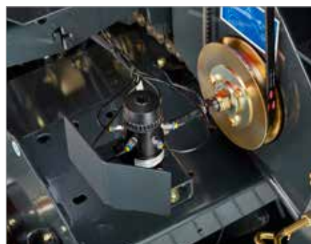
5. Система непрерывной смазки цепей ВЕКА-MAX
