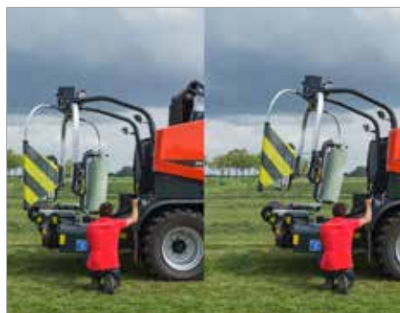
8. VBP 7190: встроенные возможности регулировки обмотчика для выгрузки тюков размером более 1,60 м
