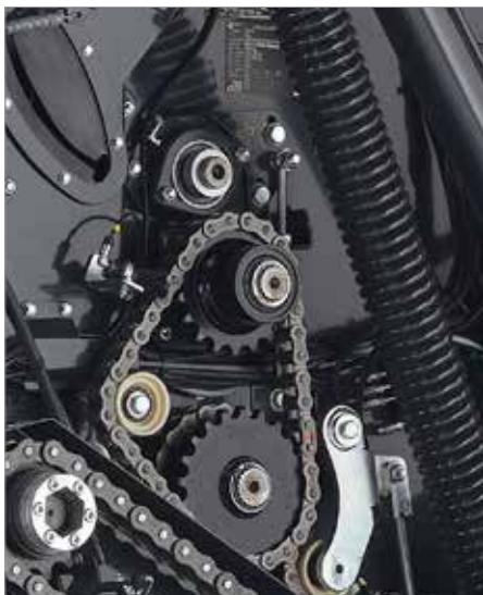
1. Второй ведущий ролик обеспечивает надежную работу ременного привода при любом состоянии культур
