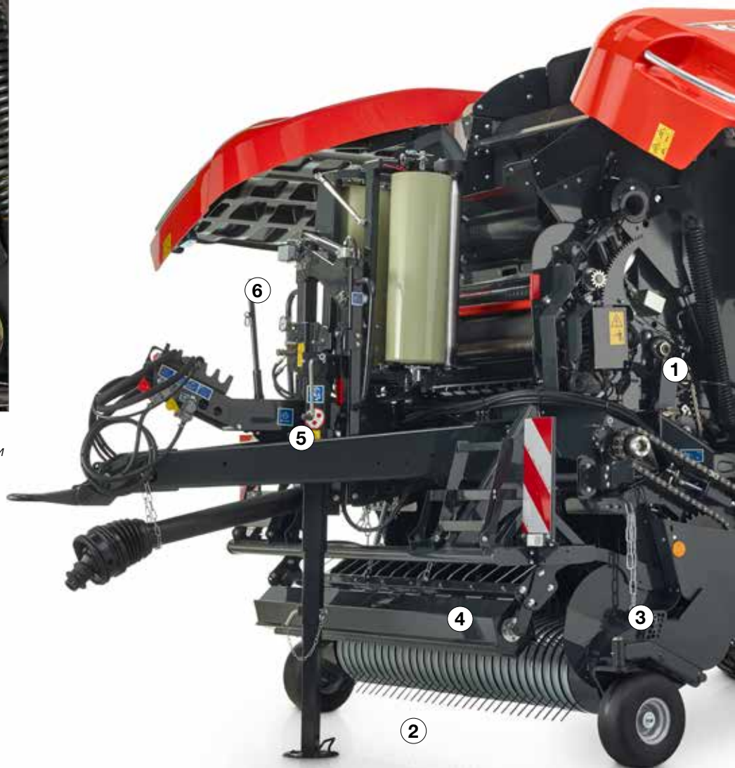
1. Второй ведущий ролик обеспечивает надежную работу ременного привода при любом состоянии культур
