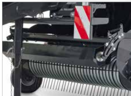
5. Подпружиненные зубья и тяжелый ролик для обработки культур (Ø 217 мм) повышают эффективность предварительного сжатия и перемещения культур
