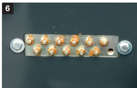
Автоматическая смазка цепей и централизованные магазины пресс-масленок для роликовых подшипников
