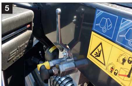
Контроль плотности POWER LOCK
