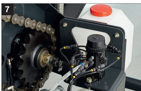
Система непрерывной смазки цепей BEKA MAX
