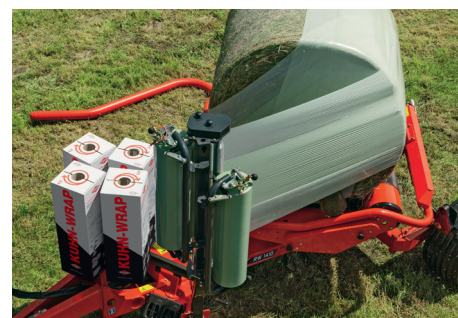
Обмотчики моделей RW 1410 и RW 1610 могут быть оборудованы предварительными натяжителями с инновационной и уникальной технологией e-TWIN
