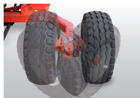
При транспортировке по дороге правое колесо можно сложить внутрь. Левое — опционально
