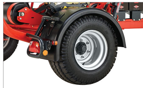
Большие грязеотражатели защищают пленку от повреждений при транспортировке
