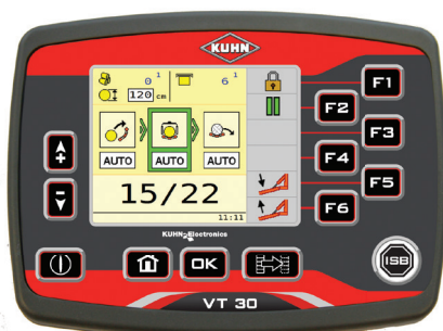
Пульт управления VT 30 с дополнительной функцией дистанционного управления
