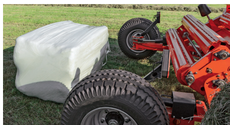
Малая высота стола позволяет аккуратно сгружать тюки и предотвращать повреждение пленки
