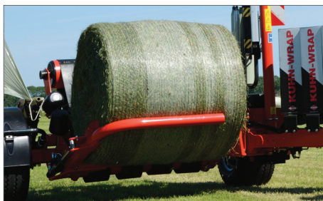
Быстрая и аккуратная погрузка рулона обеспечивается благодаря длинной погрузочной стреле
