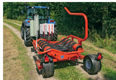
Небольшая транспортировочная ширина благодаря регулируемому положению колес
