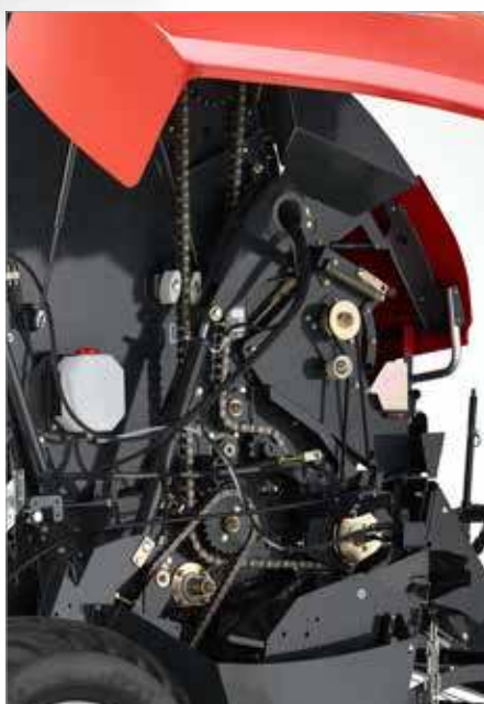
6. Надежный привод с использованием высококачественных цепей IWIS + линия первичного привода 1 1/4 дюйма 20BH с хромированными упрочненными звездочками
