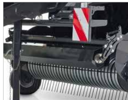
4. Подпружиненные зубья и тяжелый ролик для обработки культур (Ø 217 мм) повышают эффективность предварительного сжатия и перемещения культур
