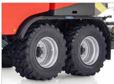
9. Сверхбольшой тандем с шинами 500/60R22,5
