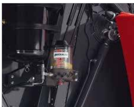
10. Автоматическая система консистентной смазки
