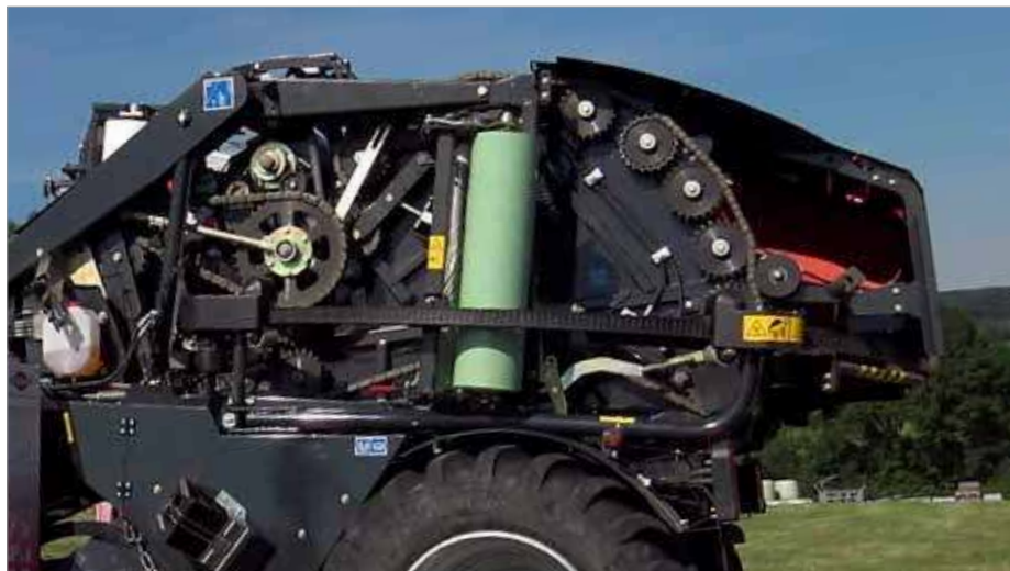
1. Надежный привод с использованием высококачественных цепей IWIS
