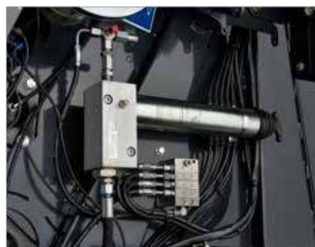
5. Стандартная система автоматической смазки роликовых подшипников
