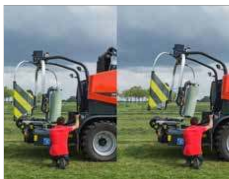
8. VBP 7190: Интегрированная регулировка обмотчика для перемещения рулонов диаметром более 1,60 м
