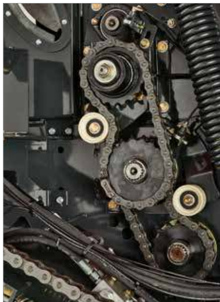
1. Второй ведущий ролик обеспечивает надежную работу ременного привода при любом состоянии культур
