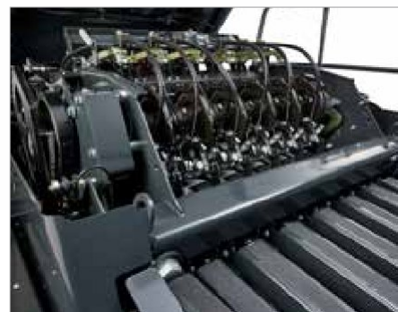
4. Система двойного узловязателя с электронным мониторингом в стандарте
