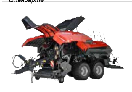
1. Система двойного узловязателя с электронным мониторингом в стандарте
