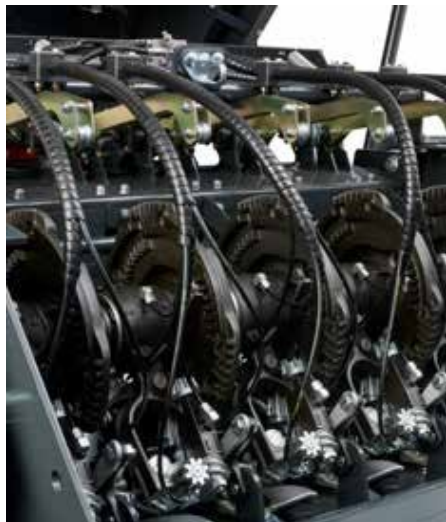
1. Система двойного узловязателя с электронным мониторингом в стандарте
