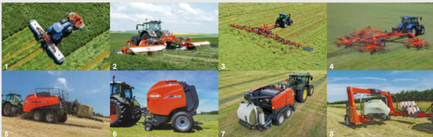
1. Косилка с тремя батареями культиваторов - 2. Косилка-плющилка с тремя батареями культиваторов - 3. Ворошилка большой ширины - 4. Грабли с четырьмя роторами - 5. Пресс-подборщик с высокой плотностью прессования - 6. Рулонный пресс-подборщик - 7. Комбинация пресс-подборщика и обмотчика с фиксированной камерой - 8. Обмотчик
