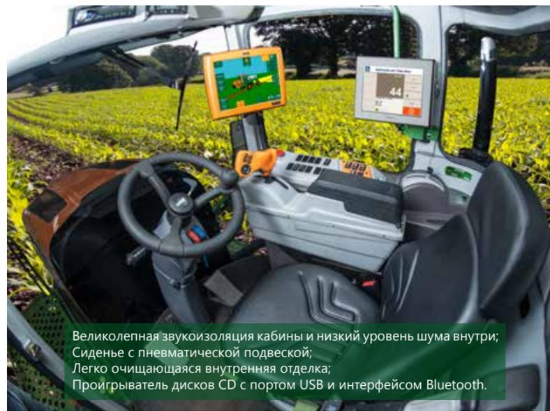
Великолепная звукоизоляция кабины и низкий уровень шума внутри; Сиденье с пневматической подвеской; Легко очищаемая внутренняя отделка; Проигрыватель дисков CD с портом USB и интерфейсом Bluetooth.
