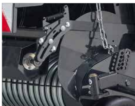
4. Подпружиненные пальцы и тяжелый прижимной валец (Ø 217 мм) для улучшения предварительного сжатия и подачи культур
