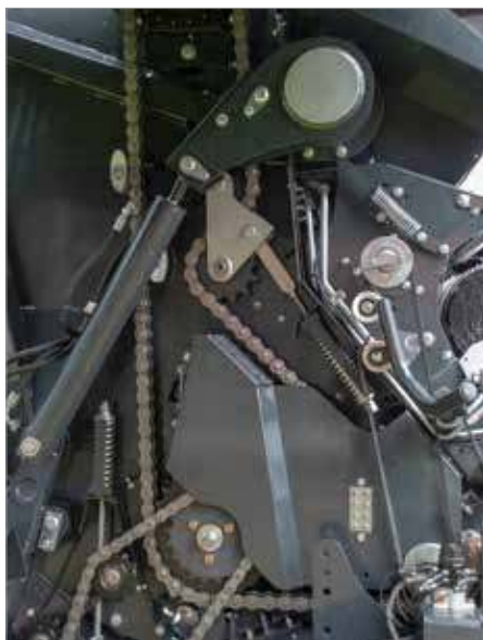
10. Надежная трансмиссия с износостойкими цепями увеличенного размера
