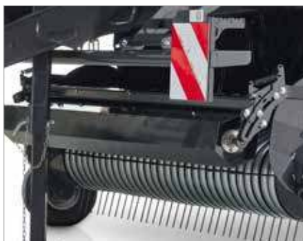
5. Подпружиненные пальцы и тяжелый прижимной валец (Ø 217 мм) для улучшения предварительного сжатия и подачи культур
