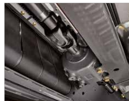
7. Усиленные передачи в приводных мостах
