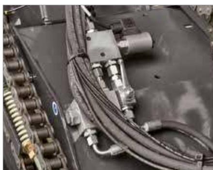
6. Управление ножами / DROPFLOOR из кабины трактора
