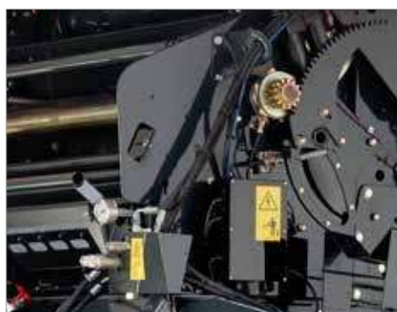
6. Система повышения давления PROGRESSIVE DENSITY PLUS
