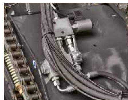
5. Управление ножами / Dropfloor из кабины трактора (опционально для OPTIFEED)
