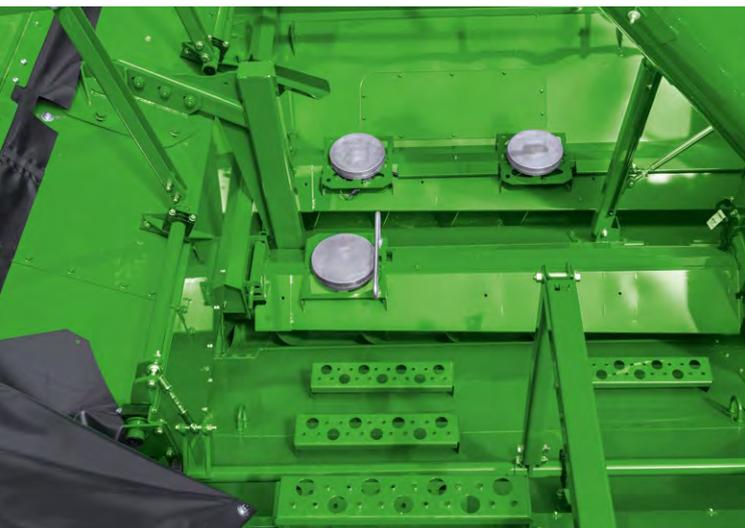
Три датчика определяют вес зерна.
