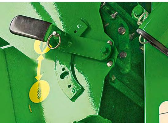
Данная система действует как система повторного обмолота, которая работает с недомоленной культурой. Это позволяет шире открыть подбарабанье, а также сократить потребление мощности и расход топлива. В то же время имеет место дополнительное преимущество, связанное с повышением качества соломы, так как культура не спрессовывается между подбарабаньем и ротором. Уменьшение объема недомоленных колосьев также позволяет еще больше открывать нижнее решето, что увеличивает производительность.
