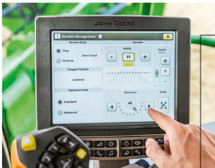
Направление и ширину разбрасывания можно удобно регулировать из кабины по ходу работы. После поворота на разворотной полосе достаточно нажатия кнопки, чтобы поменять положения направляющих лопаток с целью компенсации направления ветра.
