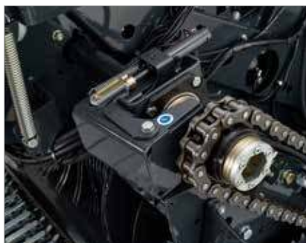
4. Гидравлическое отключение ротора из кабины
