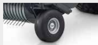
Полупневматические поворотные направляющие колеса подборщика
