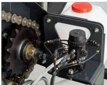
7. Система непрерывной смазки цепей ВЕКА MAX
