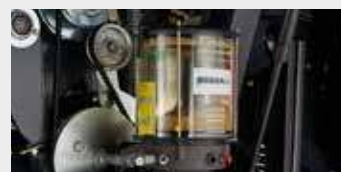
Система автоматической смазки для роликовых подшипников (контейнер 4 кг)
