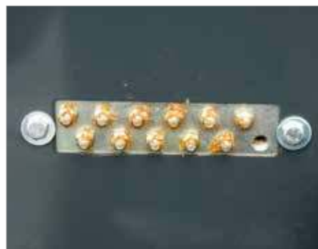
6. Централизованные магазины пресс-масленок для роликовых подшипников
