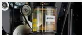
Система автоматической смазки для роликовых подшипников (контейнер 4 кг)
