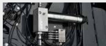
Система автоматической смазки для роликовых подшипников (картридж 400 г)
