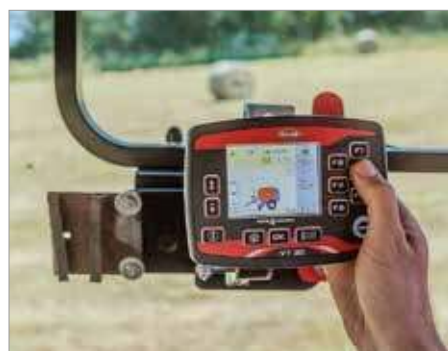
6. Контроль DROPFLOOR / ножей через терминал из кабины трактора
