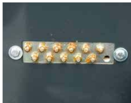
6. Централизованные магазины пресс-масленок для роликовых подшипников
