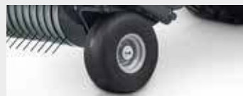
Полупневматические поворотные направляющие колеса подборщика
