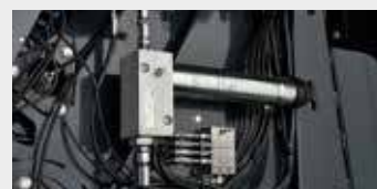
Система автоматической смазки для роликовых подшипников (картридж 400 г)
