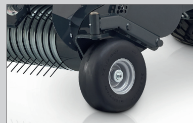
Полупневматическое поворотное колесо из полиуретана
