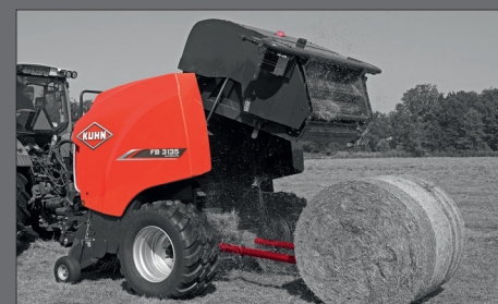
Выталкиватель рулонов обнаруживает, когда рулон находится вне досягаемости. Задний люк не открывается шире, чем необходимо. Задний люк закрывается автоматически
