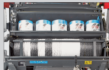
Система обвязки шпагатом и сеткой
