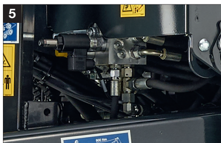
Контроль плотности POWER LOCK
