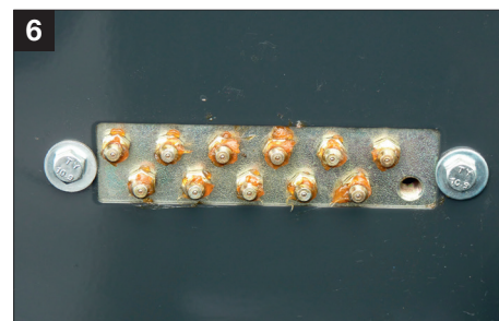
Централизованные магазины пресс-масленок для роликовых подшипников
