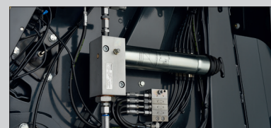
Система автоматической смазки для роликовых подшипников
