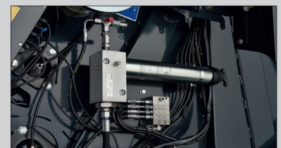
Система автоматической смазки для роликовых подшипников
