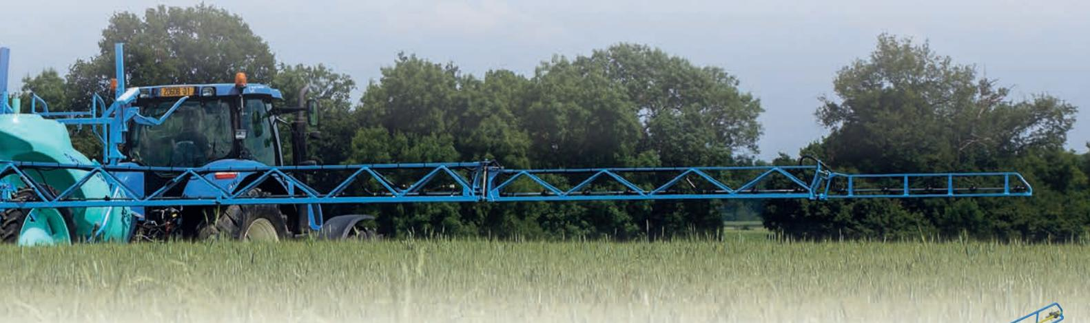
**Штанга ALS:** предлагается с рабочей шириной 18, 20, 21 и 24 м и состоит из подвески штанги Axiale и плеча L-образной конструкции.
