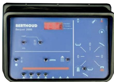
В порядке опции данный монитор поочередно отображает норму л/га и скорость движения.
