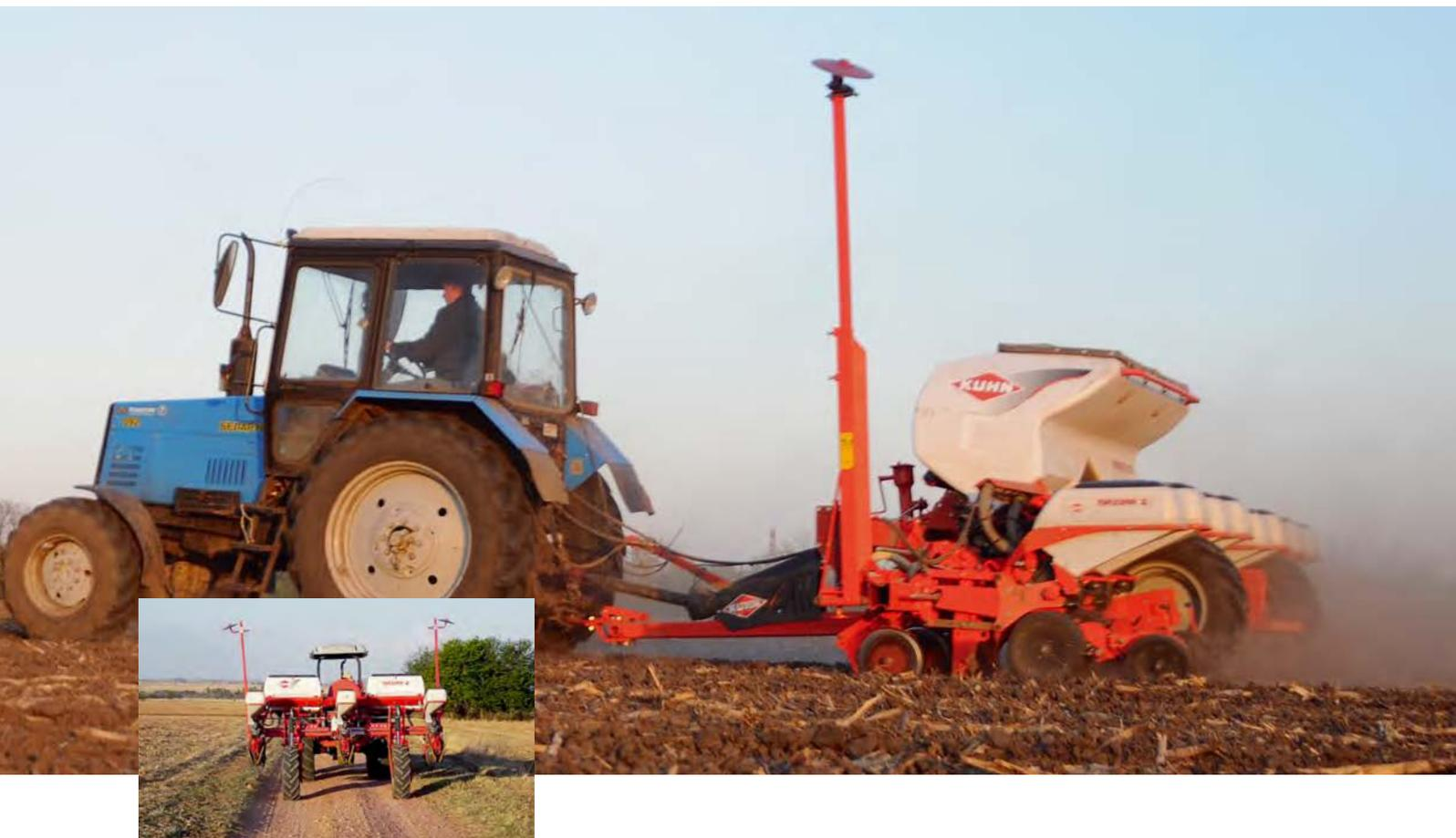
МАХИМА 2 ТМ была спроектирована для тракторов небольшой мощности от 80 л.с. Прицепные сеялки с цельной рамой поставляются в модификации от 3 до 8 рядов, в зависимости от нужного размера междурядья.
