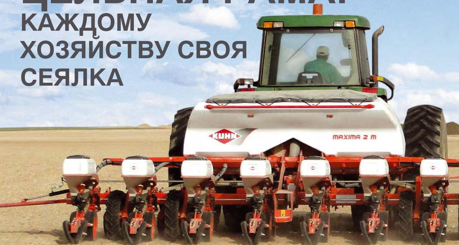
МАХИМА 2 TS с одиночной телескопической рамой имеет транспортную ширину от 3,30 до 3,50 м в зависимости от междурядья.
