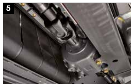
Усиленные передачи в приводных мостах
