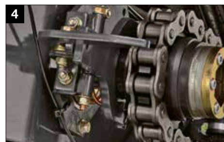
Механическое отключение ротора
