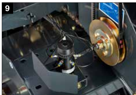
9 Система непрерывной смазки цепей BEKA MAX
