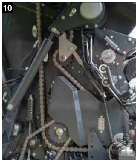
10 Надежный привод с износостойкими и крупноразмерными цепями
