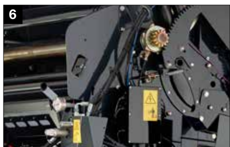
6 Пропорциональный клапан для контроля плотности из кабины
