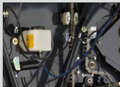
Автоматическая система смазки цепей
