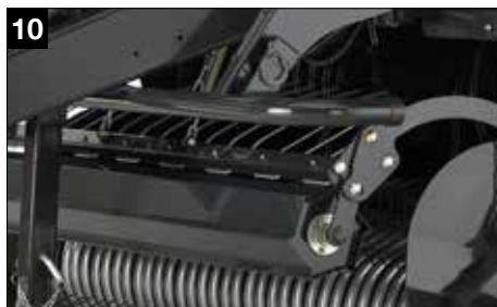
10 Усиленный ролик для обработки культуры с ветровым щитом (Ø 217 мм)
