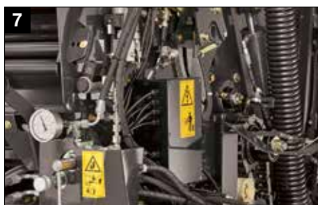
7 Пропорциональный клапан для контроля плотности из кабины
