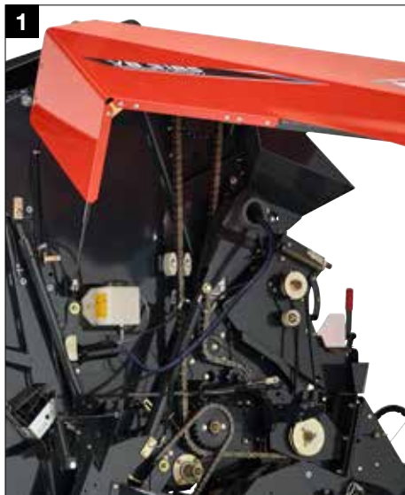
Надежный привод с использованием высококачественных цепей IWIS
