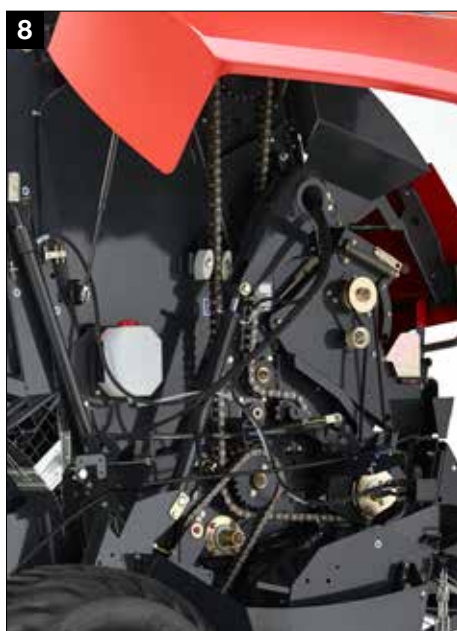
8 Надежный привод с использованием высококачественных цепей IWIS + линия первичного привода 1¼ дюйма 20BH с хромированными упрочненными звездочками
