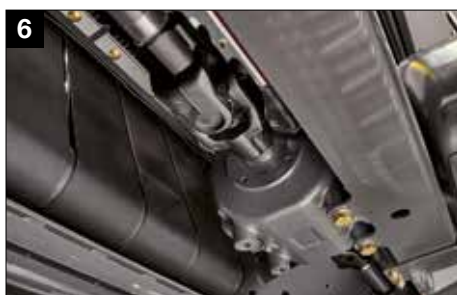
6 Усиленные передачи в приводных мостах
