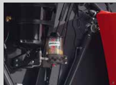
8 Автоматическая система консистентной смазки
