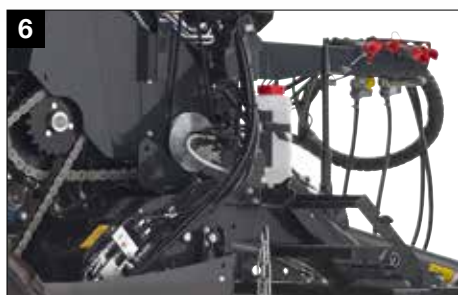
6 Система непрерывной смазки цепей VEKA-MAX
