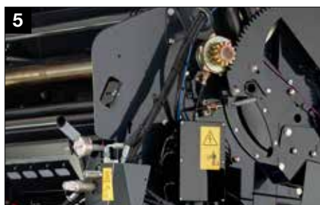
5 Пропорциональный клапан для контроля плотности из кабины
